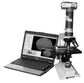
Le dispositif présente de nombreux avantages : Réglage des paramètres de l'APN (la télécommande d'origine ne permet pas l'accès à toutes les fonctions) mais surtout : pré-visualisation sur l'écran du PC, visualisation de la prise de vue, stockage des images soit sur l'APN, soit directement sur le PC, référencement immédiat des images, intervallomètre ..
